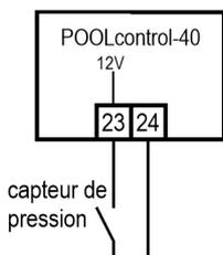
Un pressostat qui est installé dans la conduite sous pression ou dans le pressostat de la vanne centrale, peut être raccordé aux bornes 23 et 24. Si le contact sans potentiel du pressostat est fermé pendant au moins 10 secondes, le processus de retour d'eau démarre.
