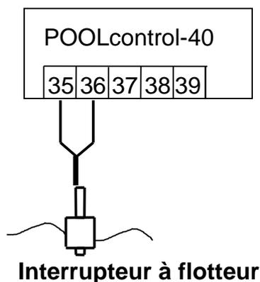
Un mini-interrupteur à flotteur **nsi** est à utiliser comme capteur pour les bassins avec skimmer. Le câble de l'interrupteur à flotteur peut être rallongé avec un câble (2 x 0,75 mm<sup>2</sup>) jusqu'à 30 m. Il est à noter que le raccordement doit être impérativement étanche. Le câble de raccordement de l'interrupteur à flotteur ne doit pas être posé avec d'autres conduites sous tension.
