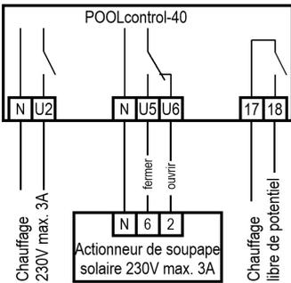
Le chauffage de la piscine peut être raccordé à la borne U2. Cette sortie fournit 230 V et peut être chargée jusqu'à max. 3 A.
