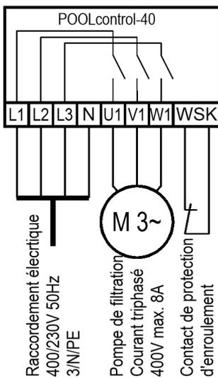
Le pont introduit à l'usine entre les deux bornes WSK doit être enlevé si l'on branche une pompe avec contact de protection de l'enroulement. Si la pompe n'a pas de contact de protection de l'enroulement, elle doit rester vissée. Ces bornes sont sous tension !
