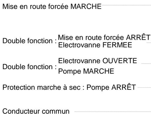
En mode normal, le niveau de l'eau oscille entre les électrodes « Electrovanne FERMÉE » et « Electrovanne OUVERTE »
