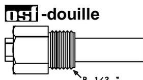
Etant donné qu'une régulation exacte de la température n'est réalisée qu'avec une bonne transition de chaleur entre le capteur de température et l'eau de la piscine, une douille immergée PSI R 1/2 " (réf. 320.020.0003) doit être installée dans le système de conduites.
