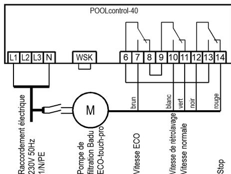
Une pompe Speck ECO-Touch-Pro peut être branchée directement sur le PC-40. Le contrôle de la vitesse est raccordé aux bornes 6-14.
