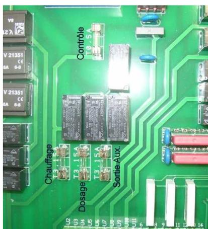
La commande électronique est protégée par un fusible pour courant faible 0,5 A sur le circuit imprimé à l'intérieur de l'appareil. Pour le chauffage, la technique de dosage et la sortie auxiliaire, un fusible pour courant faible 3,15 A est respectivement disponible. La protection contre les courts-circuits pour la pompe de filtrage doit être assurée par des pré-fusibles de max. 16 A incombant au client.
