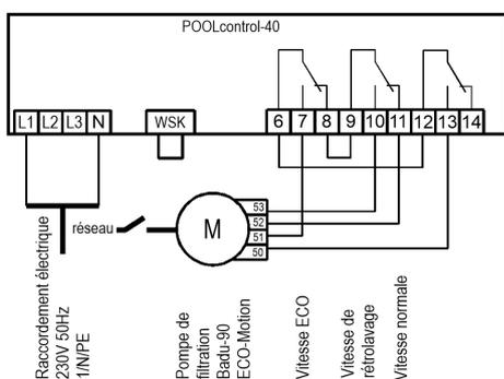
Une pompe Speck Badu-90-ECO-Motion peut être branchée directement sur le PC-40. Le contrôle de la vitesse est raccordé aux bornes 6-13.
