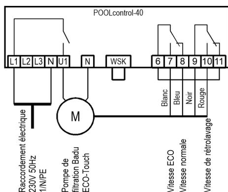
Une pompe Speck ECO-Touch peut être branchée directement sur le PC-40. Le contrôle de la vitesse est raccordé aux bornes 6-11.
