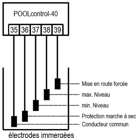
Comme capteurs, il faut utiliser des électrodes immergées **TSI**.
