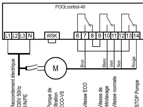
Une pompe Speck ECO-VS peut être branchée directement sur le PC-40. Le contrôle de la vitesse est raccordé aux bornes 6-14.
