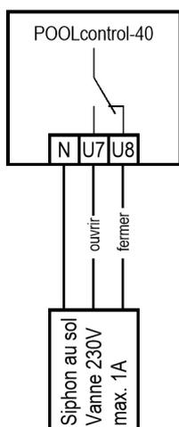
Une vanne d'évacuation au sol (vanne ECO) ou une vanne pour un prélèvement d'eau latéral peut être raccordée. Une vanne à 2 voies est raccordée aux bornes U7 et N. Sur une vanne à 3 voies, la borne U7 pour « *OUVERT* » et la borne U8 pour « *FERME* » est utilisée. Ce contact peut être chargé avec max. 230 V/1 A.
