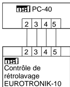
Pour le raccordement du système EUROTRONIK-10, une connexion à 4 conducteurs est nécessaire. Lors du raccordement, les conducteurs ne doivent pas être intervertis. Le système EUROTRONIK-10 nécessite en plus une alimentation séparée.
