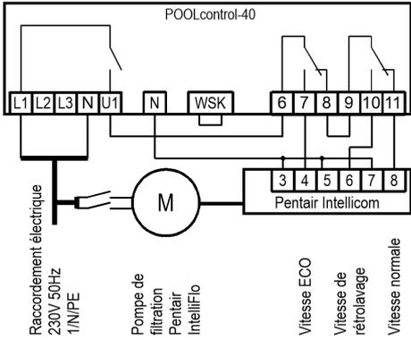
Une pompe IntelliFlo peut être commandée par le PC-40 à l'aide de la commande Pentair Intellicom.
