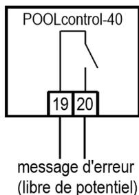
Une signalisation de défaut externe peut être raccordée aux bornes sans potentiel 19 et 20. Ce contact peut être chargé avec max. 230V/4A.
