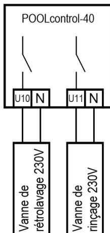
Une vanne automatique 230 V pour le rétrolavage peut être raccordée sur les bornes U10 et N.
