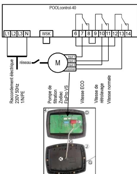
Une pompe Zodiac FloPro VS peut être branchée directement sur le PC-40. Le contrôle de la vitesse est raccordé aux bornes 6-13.
