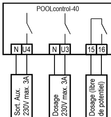
Un équipement auxiliaire 230 V (par ex. projecteur immergé) qui peut être mis en marche et à l'arrêt comme on le souhaite avec une minuterie interne dans la commande, peut être raccordé à la borne U4. Etant donné que cette sortie est configurable, elle peut être également utilisée pour la commande d'une pompe de floculation.
