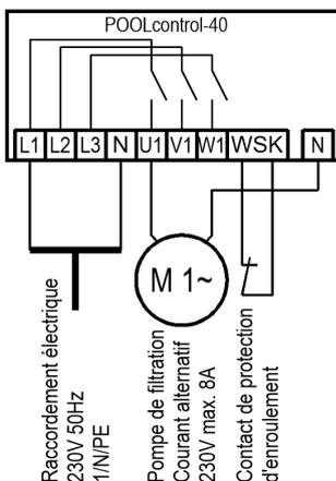
Le pont introduit à l'usine entre les deux bornes WSK doit être enlevé si l'on branche une pompe avec contact de protection de l'enroulement. Si la pompe n'a pas de contact de protection de l'enroulement, elle doit rester vissée. Ces bornes sont sous tension !
