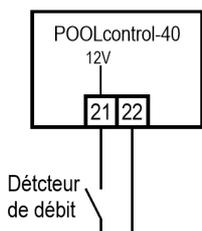
A la place du pont introduit à l'usine entre les bornes 21 et 22, un contrôleur de débit ou un pressostat peut être raccordé pour protéger en plus la pompe d'un fonctionnement à sec. Son contact doit être fermé en mode de filtrage au plus tard 10 secondes (réglage usine, plage de réglage 5-60 s) après la mise en route de la pompe de filtrage, sans quoi cette dernière est arrêtée et le voyant de signalisation de défaut s'allume. En mode de retour d'eau, ce contact n'est pas demandé.
