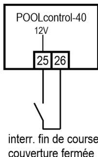
Un commutateur de fin de course de la couverture de piscine qui démarre automatiquement le mode ECO lorsque la couverture est fermée, peut être raccordé sur les bornes 25 et 26.
